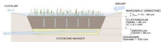
Figur 1. Regnbød på leirejord, med utskiftet filtermedium og drenering.
